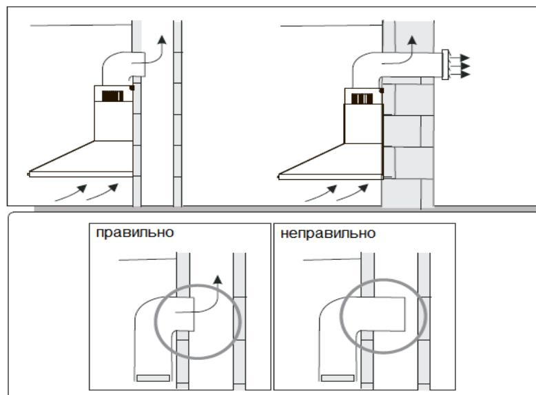
Рекомендовано використовувати діаметр повітряводу рівний діаметру переходника виходу з агрегату та робити якомога плавніше та менше поворотів до місця викиду повітря на вулицю. В інакшому випадку це призведе до значного збільшення шумових характеристик витяжки та значного зменшення потужності (м3/г).
