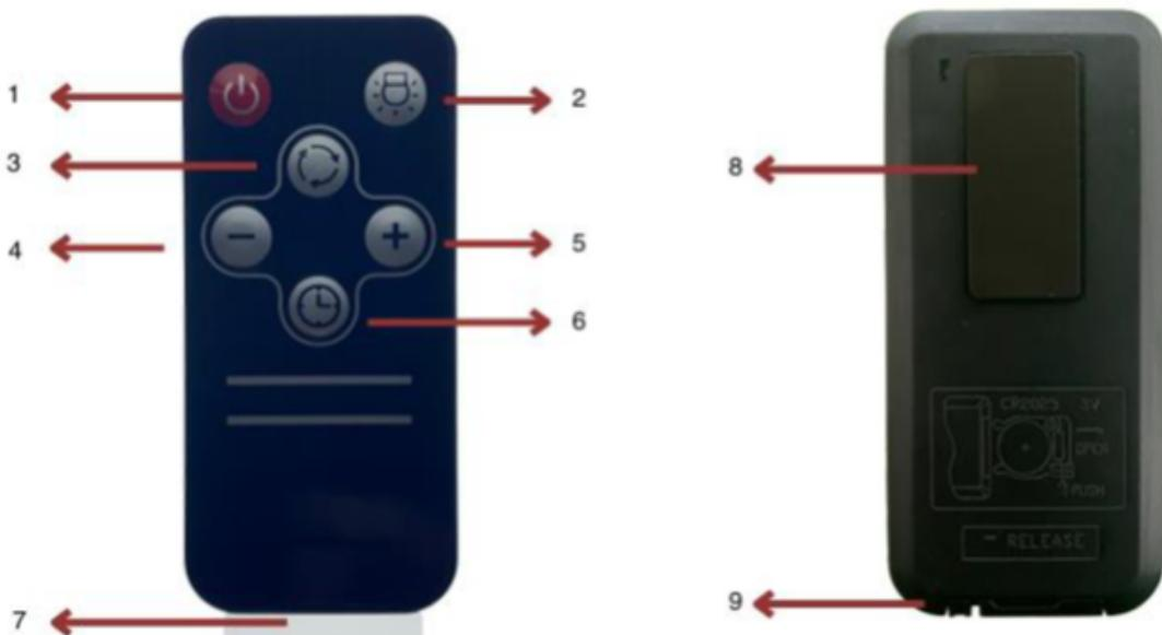
Натисніть кнопку **1**, щоб запустити двигун на швидкості-1. Якщо двигун уже працює, натискання кнопки вимикає його.
