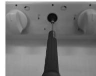
6. Обережно витягніть регулятор (використовуйте викрутку з плоским шліцом, вставлену у вісь). При закручуванні проти годинникової стрілки – максимальне полум'я, при закручуванні за годинниковою стрілкою – мінімальне полум'я.
