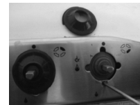
6. Обережно витягніть регулятор (використовуйте викрутку з плоским шліцом, вставлену у вісь). При закручуванні проти годинникової стрілки – максимальне полум'я, при закручуванні за годинниковою стрілкою – мінімальне полум'я.
