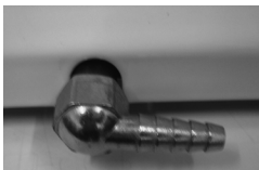
7. Відкрутіть кронштейн впуску зрідженого газу. Замініть гнучкий шланг для підключення до мережі постачання природного газу
