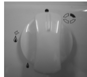
6. Обережно витягніть регулятор (використовуйте викрутку з плоским шліцом, вставлену у вісь). При закручуванні проти годинникової стрілки – максимальне полум'я, при закручуванні за годинниковою стрілкою – мінімальне полум'я.
